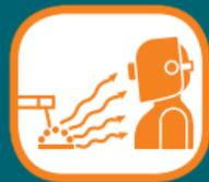
**PROTEGERSE** los ojos y la cara con un casco de soldador correctamente ajustado y con una placa filtrante del grado adecuado (Ver ANSI Z49.1).
