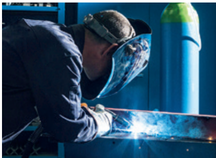
Manual MIG welding
