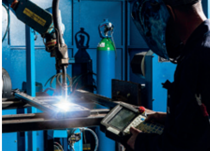
Robotic MIG welding
