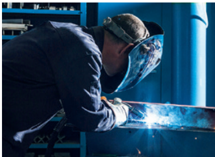
Manual MIG welding
